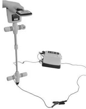
Konfigurasjon for å Testet et Konduktive Settet
